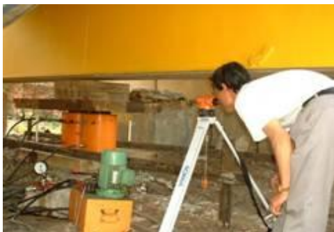
Hình 2.20. Sơ đồ bố trí thí nghiệm thử tải tĩnh
