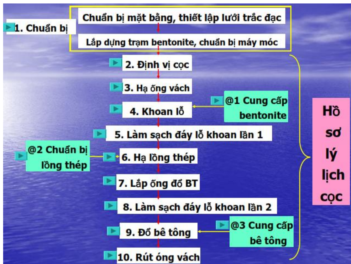
Hình 1.1. Sơ đồ thi công cọc khoan nhồi
