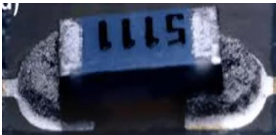
Hình 1.31 Linh kiện được đặt lên vị trí đã được quét kem hàn
