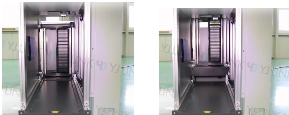
Hình 1.18 Magazine di chuyển đến Lifter sau đó được nâng đến vị trí thao tác
