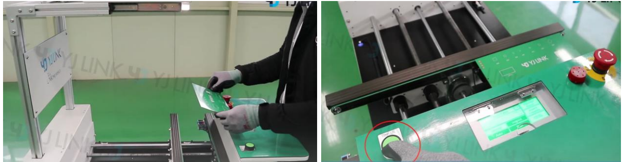
Hình 1.41 Công nhân kiểm tra ngoại quan PCB
