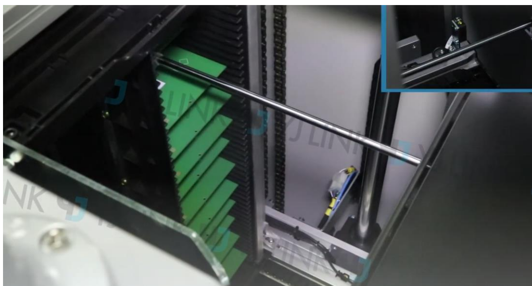
Hình 1.19 Pusher đẩy PCB ra khỏi Magazine
