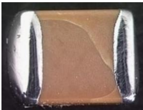
Hình 1.51 Vết nứt trên tụ điện xảy ra trong quá trình hàn reflow soldering
