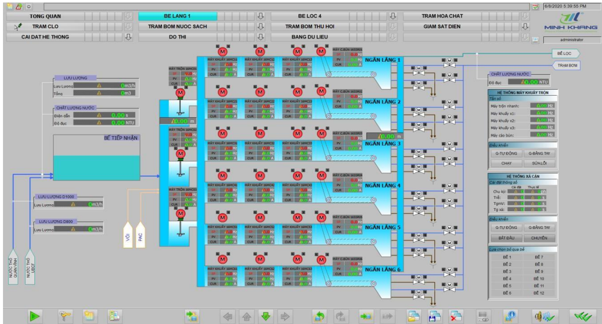
Hình 3.25: SCADA bể khuấy, trộn, lắng 1
