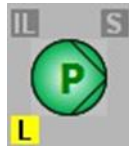
Hình 3.11: Trạng thái điều khiển, hoạt động tại chỗ
