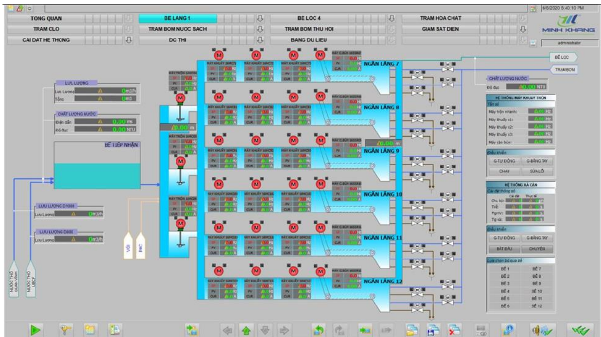
Hình 3.25: SCADA bể khuấy, trộn, lắng 1
