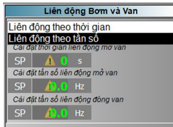
Hình 3.15: Cài đặt liên động bơm và van
