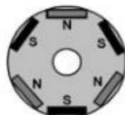
Rotor lõi tròn với nam châm hình chữ nhật được đặt trong rotor
