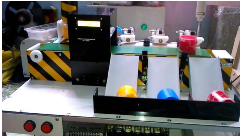
Hình 1.3: Hệ thống phân loại theo màu.
