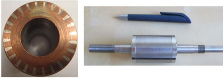
H.3.17 Rô ro nhiều lớp với thanh hình tròn
