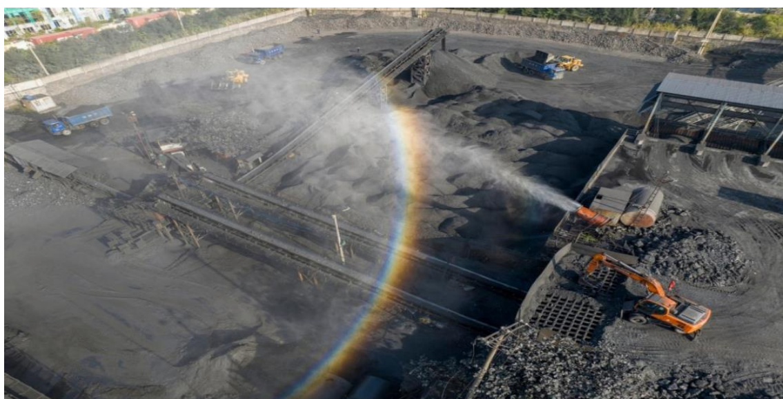
Hình 3.2. Máy phun sương cao áp dập bụi khu vực sàng, kho than.
