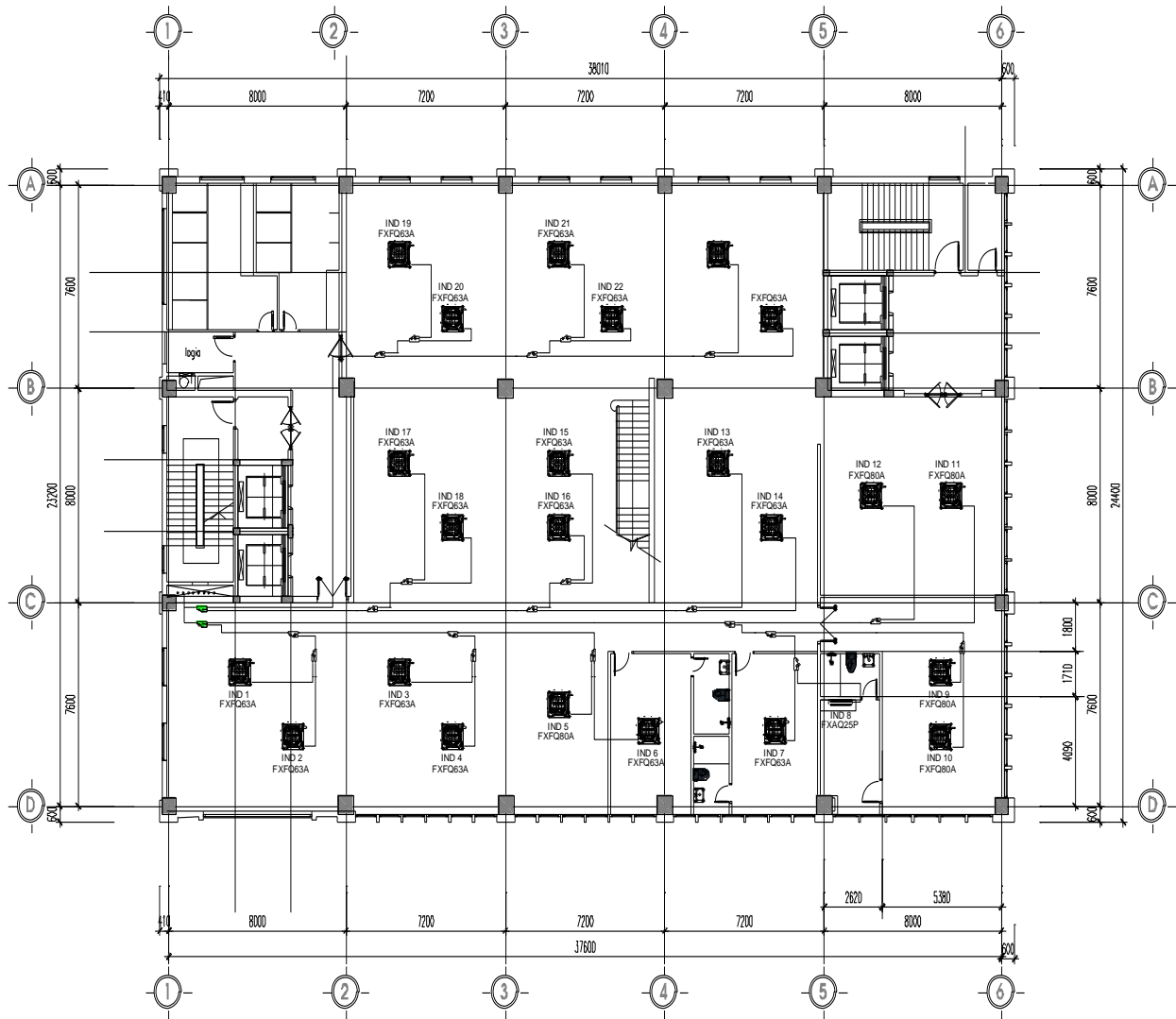
Mặt bằng điều hòa tầng 7
