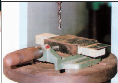
Hình 22.5. Các bước cơ bản khi khoan a) Lắp mũi khoan ; b) Kẹp vật khoan ; c) Điều chỉnh mũi khoan.
