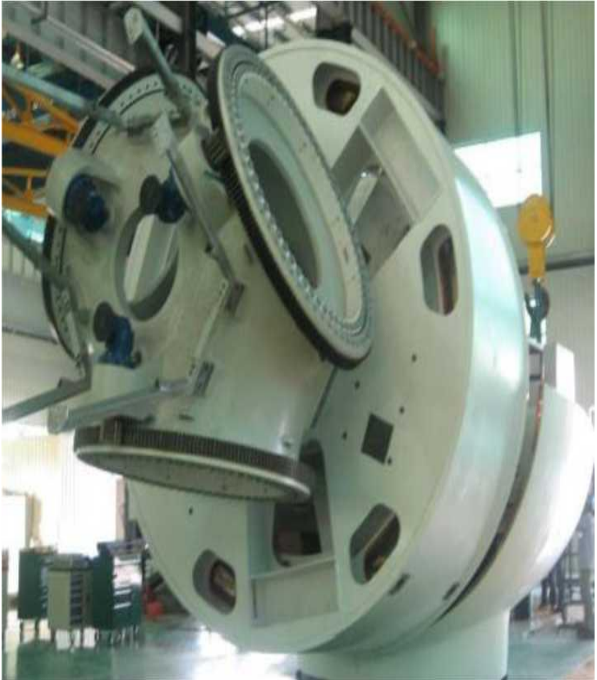
Hình 2.7: Hệ thống đùm nối cánh quạt.
