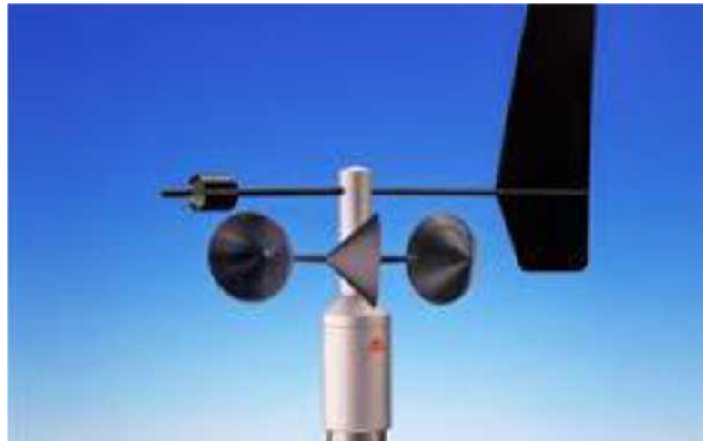
hình 2.17: Hệ thống chỉnh Tua-bin theo hướng gió.
