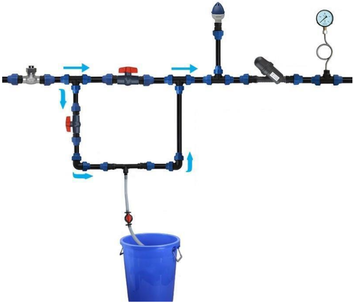
Hình 4.2.2.b: Mô tả lắp đặt thực tế
