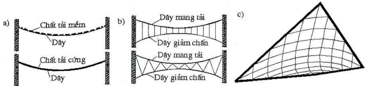
Hình 1.3 Các giải pháp ổn định mái treo
