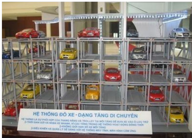
Hình 1.2: Hệ thống đỗ xe dạng tầng di chuyển
