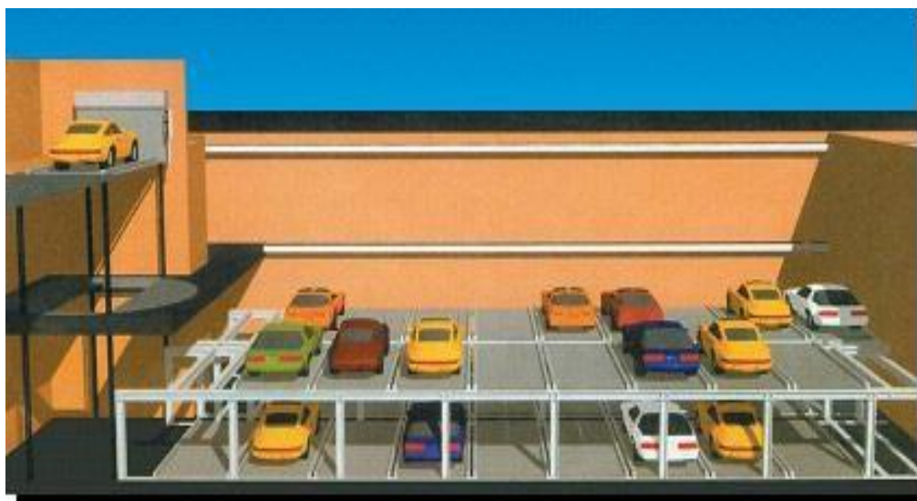
Hình 1.3: Hệ thống đỗ xe loại thang nâng dịch chuyển
