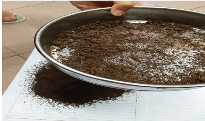
Hình 2.5. Sàng đất qua rây 0,5mm
