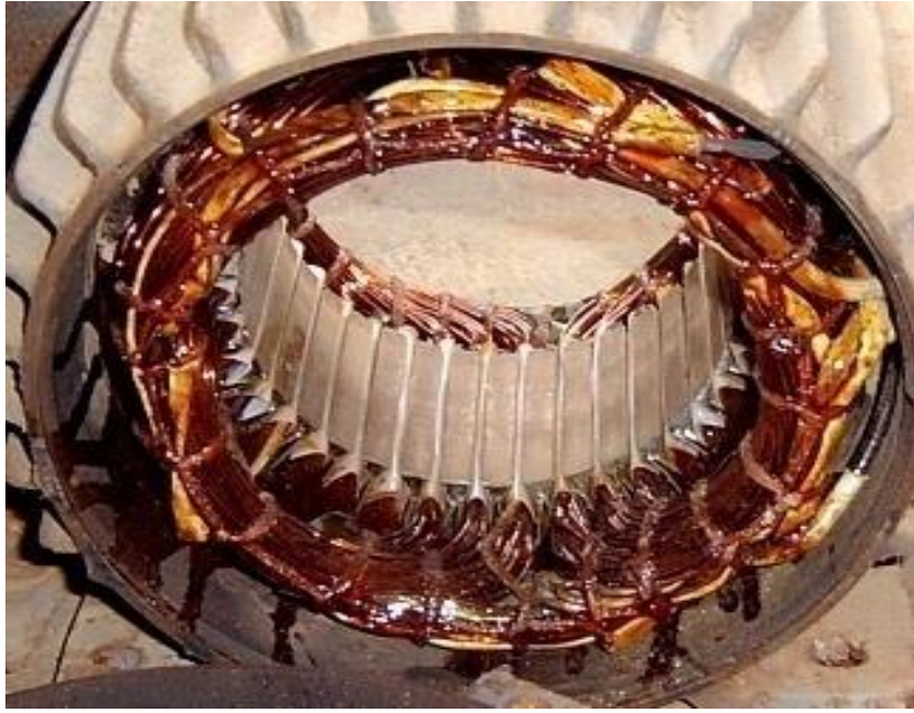
Hình1.2. Phần tĩnh của máy điện
