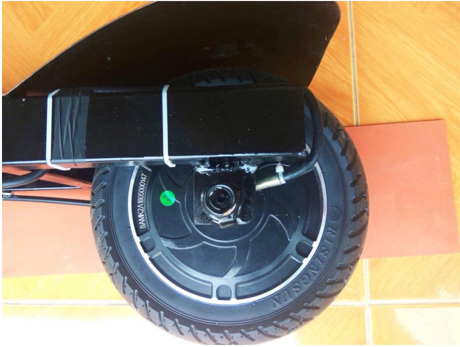
Hình 3.13: Động cơ được lắp vào khung xe đã gia công
