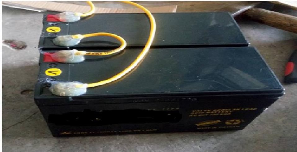
Hình 3.6: Ắc quy mắc nối tiếp.
