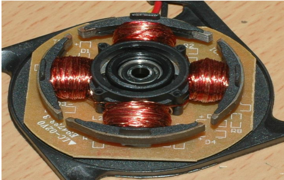
Hình 3.6: Bốn cực trên stator của một động cơ chổi than hai giai đoạn. Đây là một phần của quạt làm mát máy tính.
