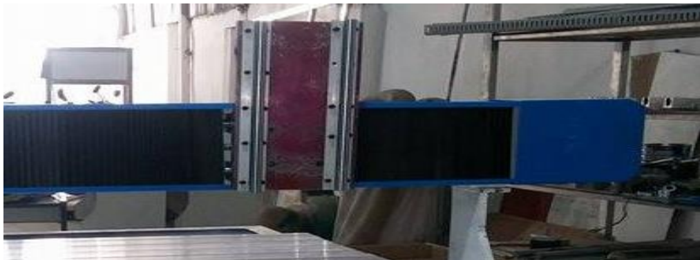
Hình 3.5: Cân chỉnh trục Z với trục Y
