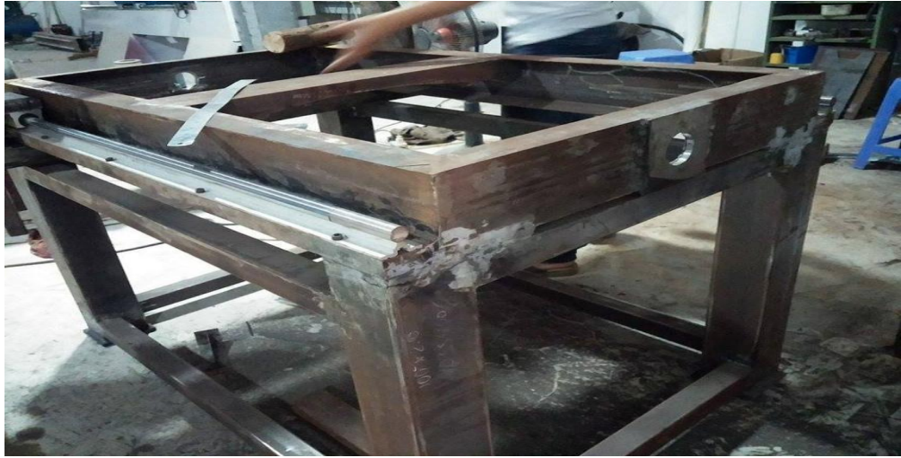
Hình 3.3: Lắp đặt sóng trượt 1
