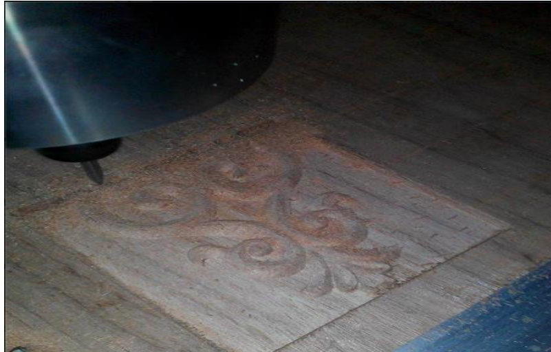
Hình 4.7: Hình ảnh mũi khoan trong khi gia công
