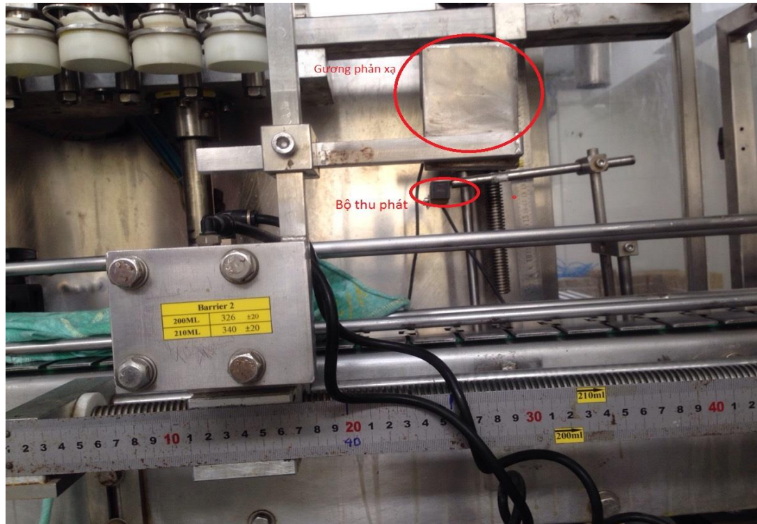
Hình 3.4: Barrier, bộ cảm biến gương, và thước giới hạn điều chỉnh barier
