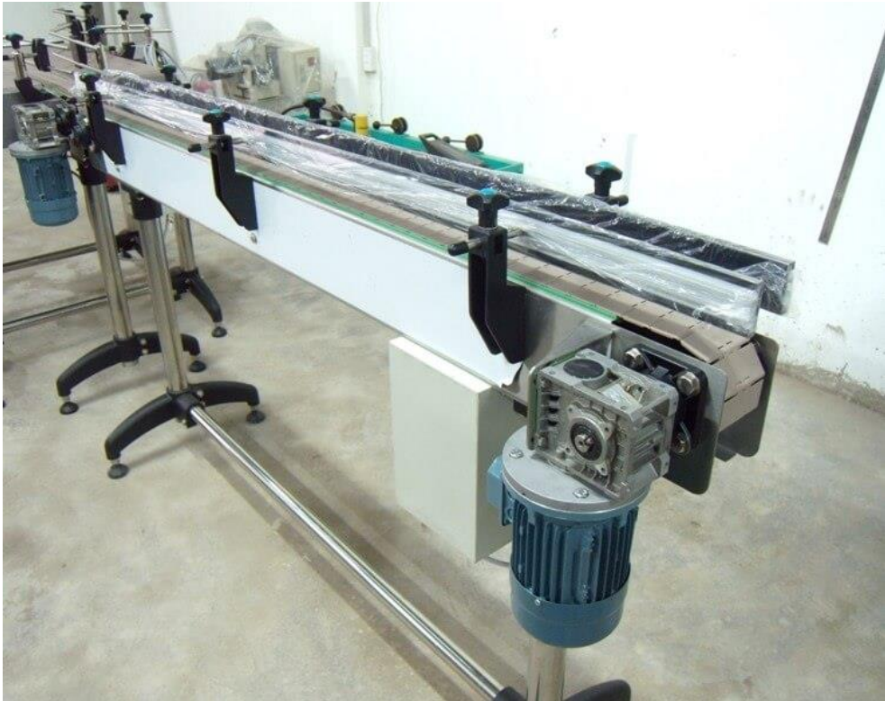
Hình 2.11: Băng tải trong nhà máy
