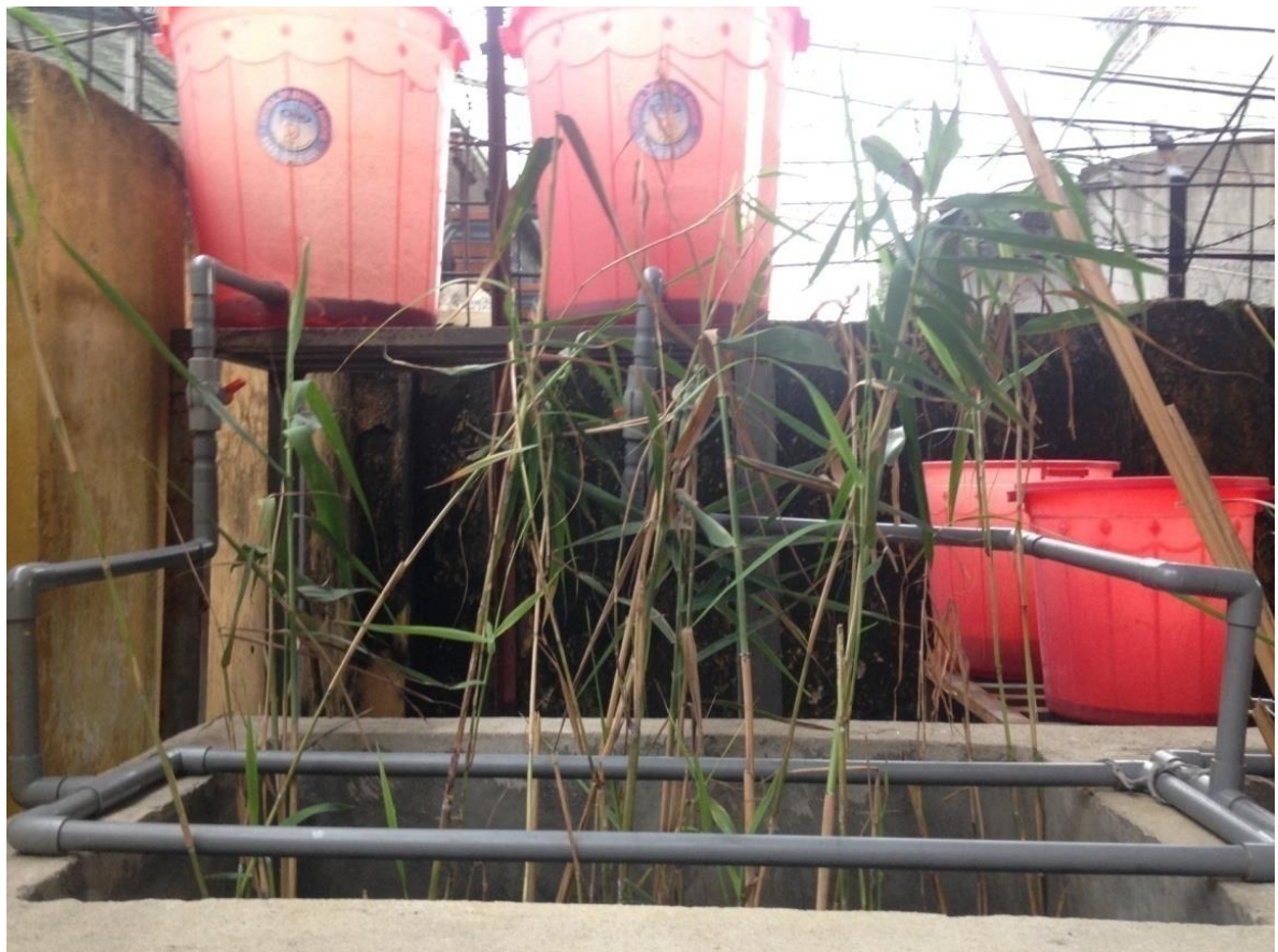
Hình 2.6. Cấu tạo mô hình bãi lọc trồng cây Sậy
