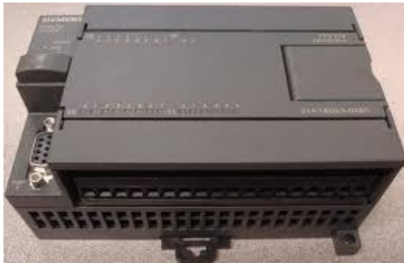
Hình 3.1: PLC S7-200 CPU 224 AC/DC/Relay
