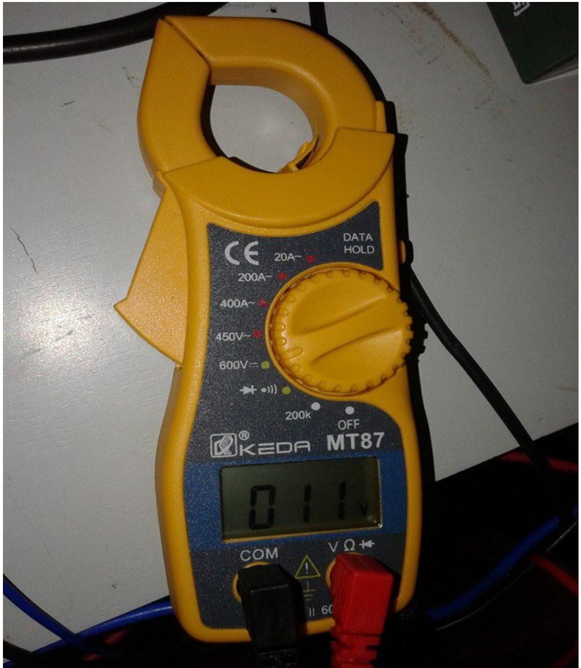
Hình 3.26: Điện áp đầu vào bộ biến đổi
