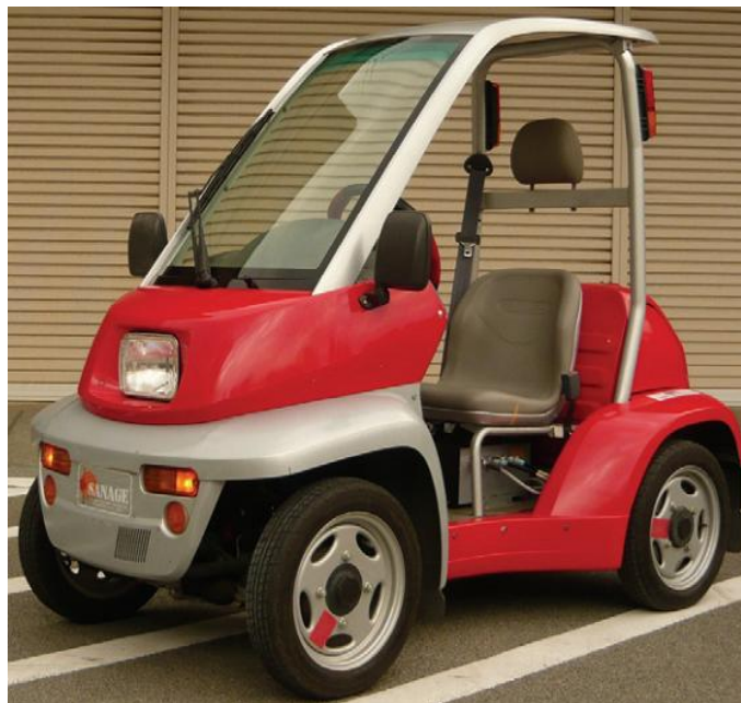
Hình 1.4. (a) Xe điện nhỏ COMS3 sử dụng siêu tụ
