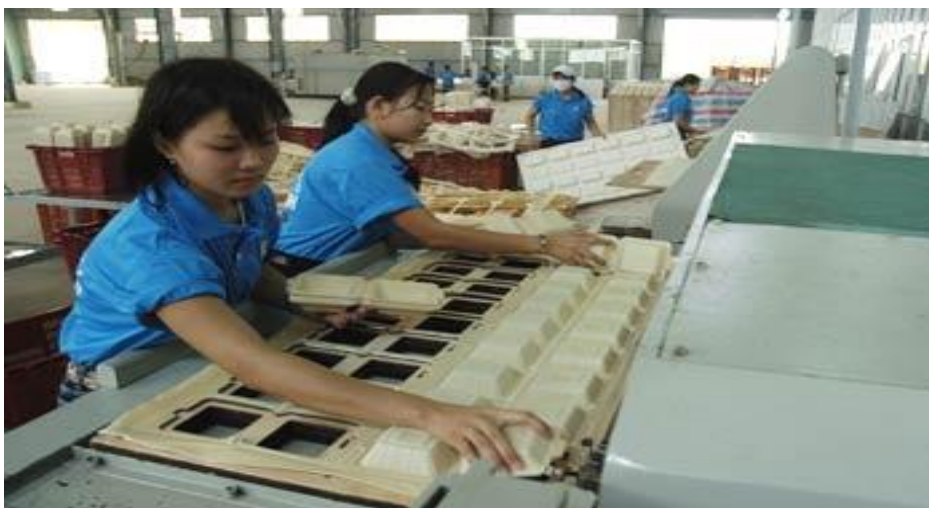
Hình 1.2. Sản xuất hộp nhựa từ tinh bột ngô
