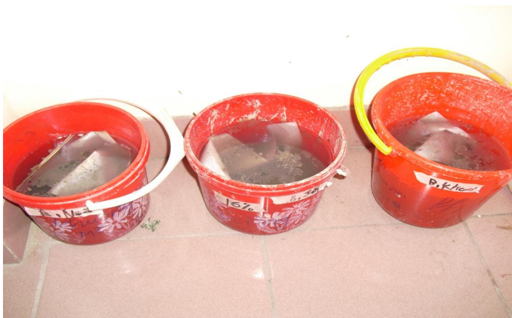
Hình 3.7. Theo dõi sự phân hủy sinh học của nhựa khi ngâm trong nước thải
