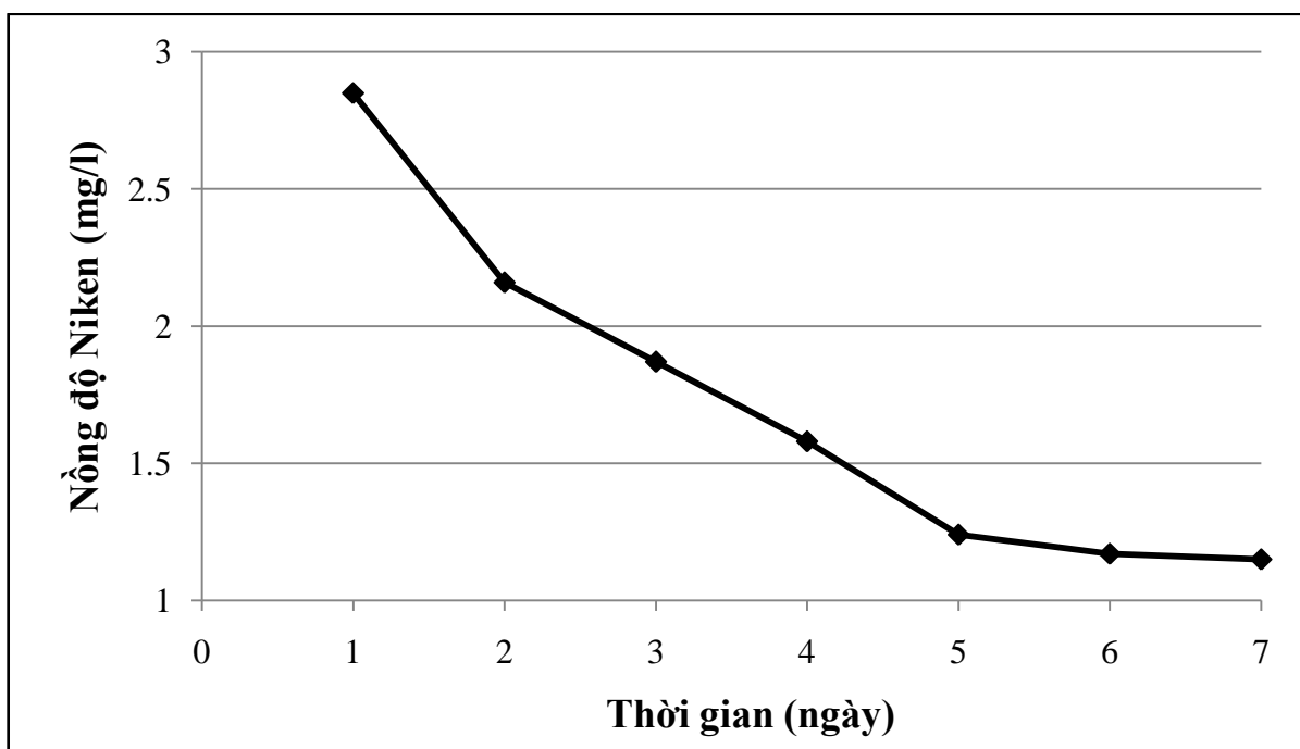
Hình 3.8: Khả năng hấp thu Niken của bèo cái khi có mặt axit Aspactic 0,01 g/l với [Ni^{2+}]_0 = 2,85 \text{ mg/l}
