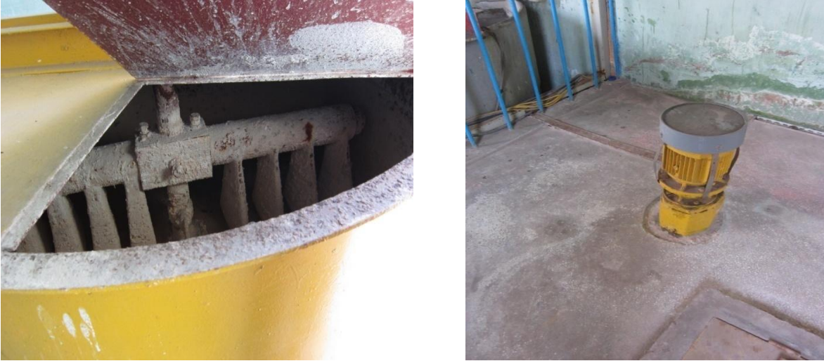
Hình 3.3: Máy trộn vôi và máy khuấy vôi
