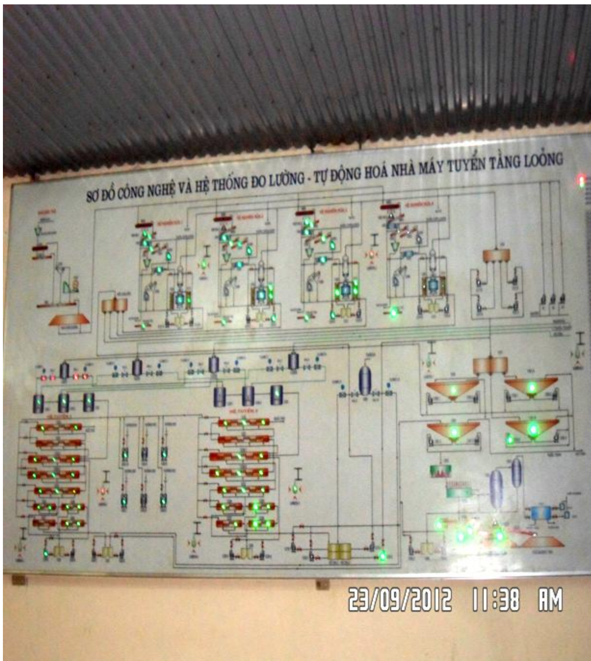
Hình 2.1. Sơ đồ công nghệ và hệ thống đo lường- tự động hóa nhà máy tuyển Tầng Lởng
