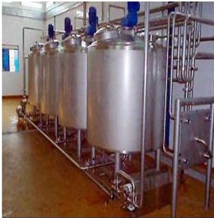
Hình 1.2: Bồn chứa tích hợp các chức năng xử lý nhiệt độ, bơm, khuấy, pha chế các thành phần dịch có độ nhớt cao
