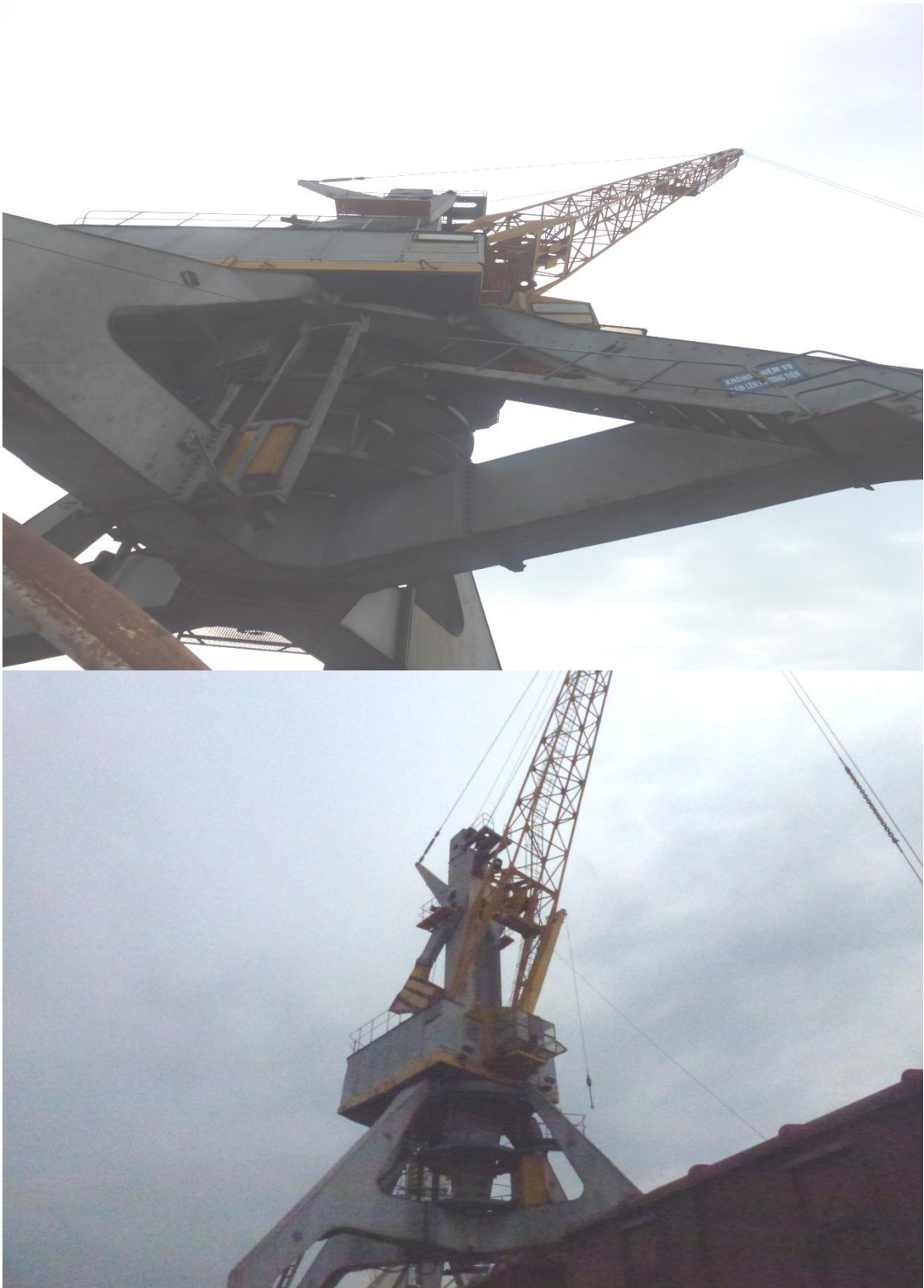
Hình 1.1 : Cần cẩu Kirov 5 tấn trang bị cho cảng biển
