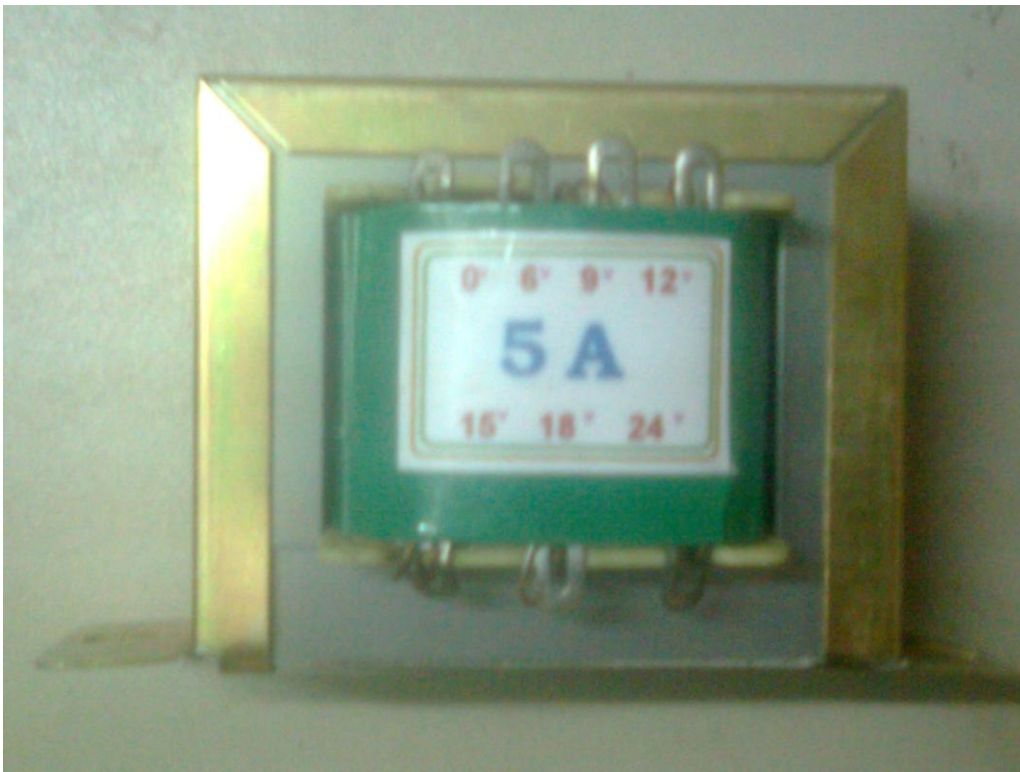
Hình 2.2.3. Biến áp cấp nguồn
