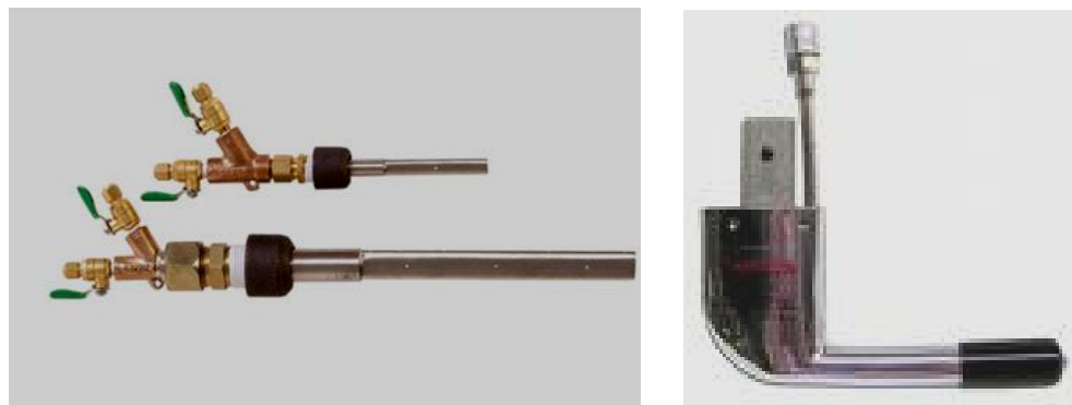
Hình 3.2: Đo áp suất động bằng ống Pitot
