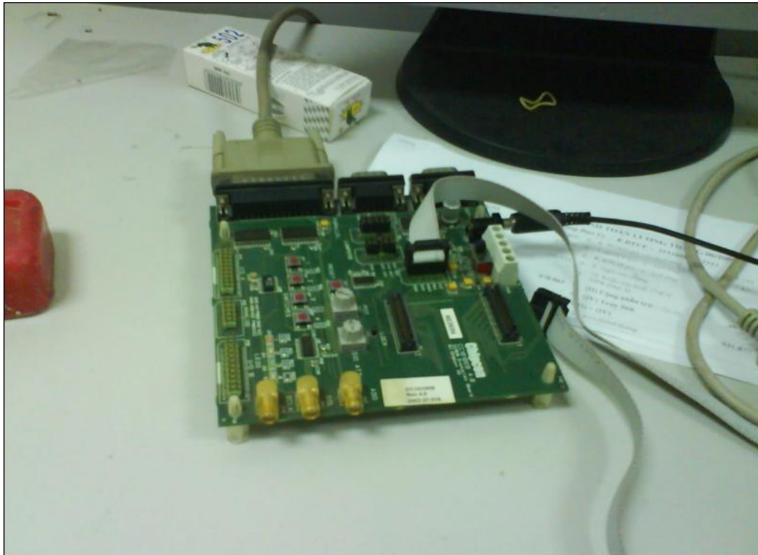
Hình 3.7 Bộ nạp chương trình_ 1 node gắn máy tính
