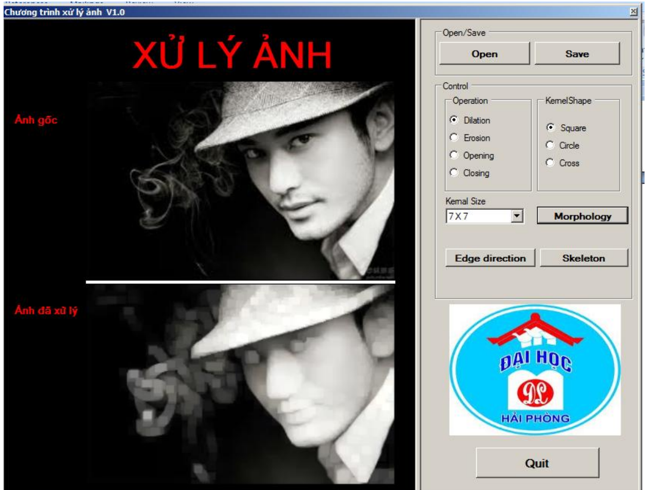
Hình 3.2: Thực hiện giãn nhị phân hình ảnh với phần tử cấu trúc 7x7
