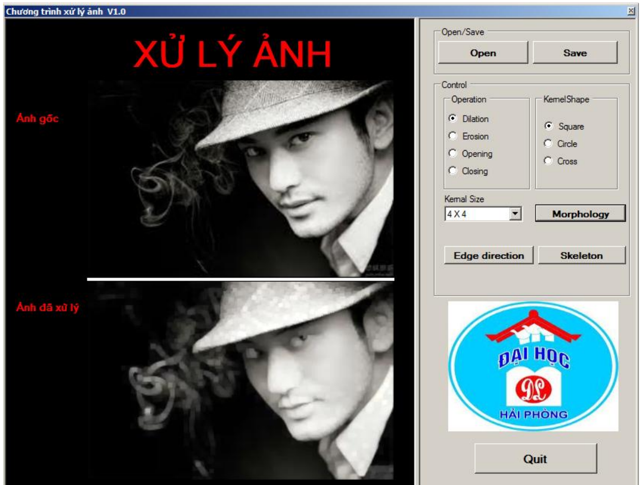
Hình 3.1: Thực nghiệm giãn nhị phân hình ảnh với cấu trúc 4x4.
