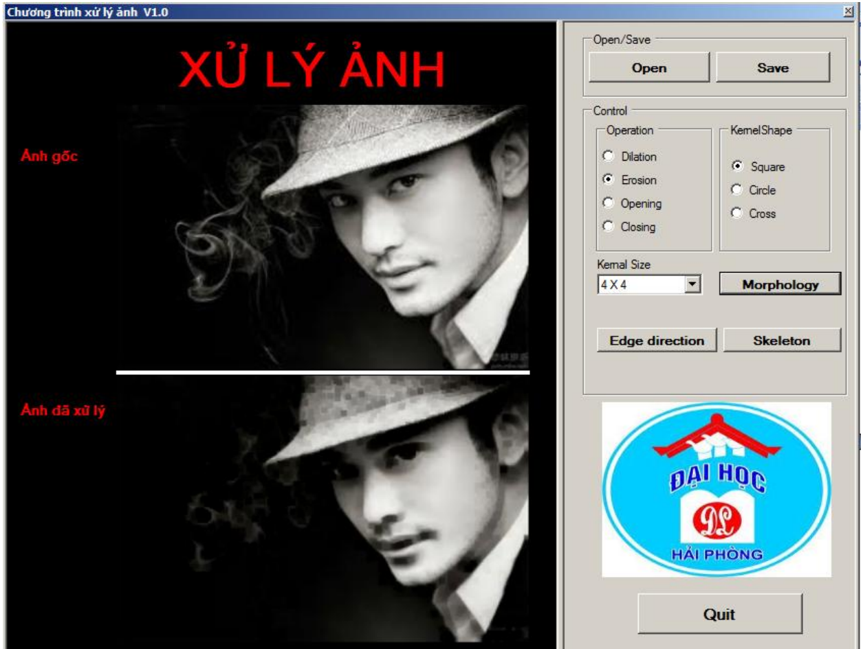
Hình 3.3: Thực nghiệm phép co nhị phân trên hình ảnh với phần tử cấu trúc 4x4.
