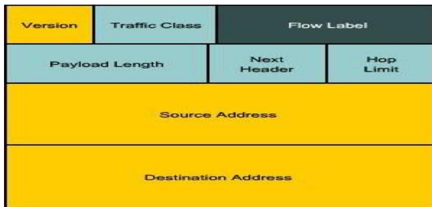
Hình 2.3. Cấu trúc Header của Ipv6
