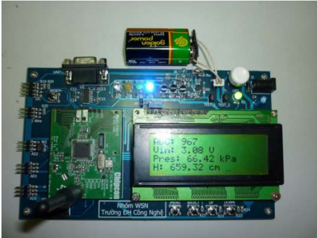
Hình 3.2: Nút mạng cảm biến có gắn màn hình hiển thị kết quả đo
