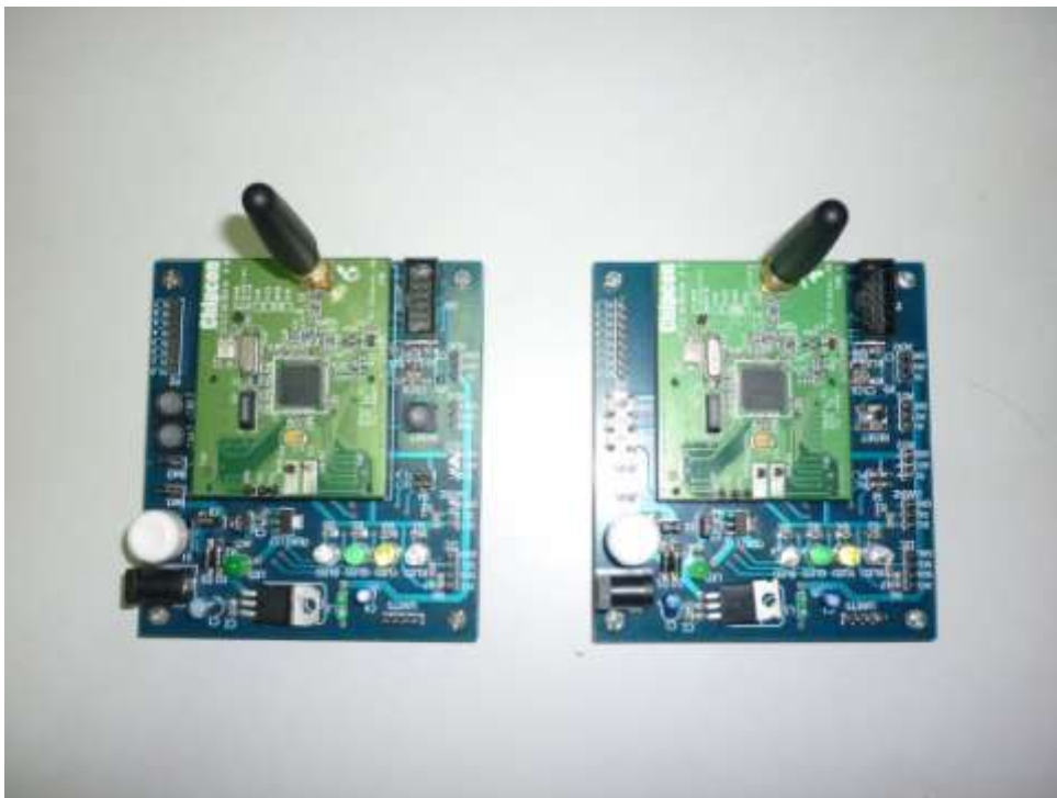
Hình 3.1: Nút cảm biến sử dụng khối EM-CC1010
