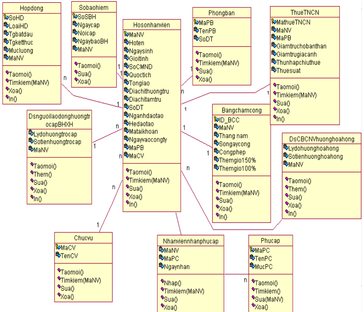
Hình 4.4: Mô hình lớp thiết kế gói cao sử dụng “Quản lý Nhân sự”
