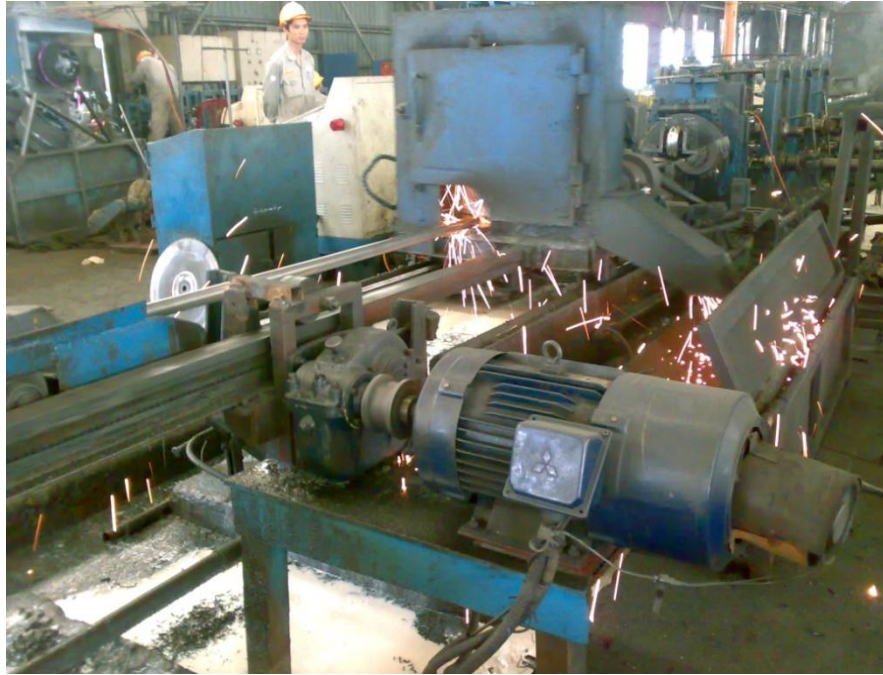
Hình 2.3: Động cơ quay lưỡi dao cắt ống.
