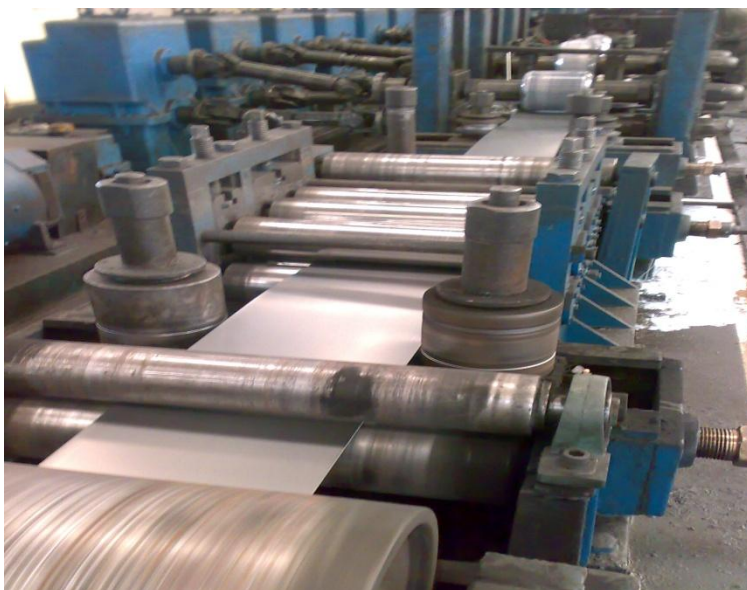
Hình 2.1: 7 quả Roll trên và 7 quả Roll dưới.
