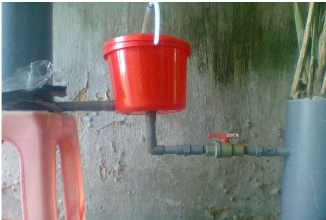
Hình 2.6: Xô yếm khí 2 và đường ống dẫn
