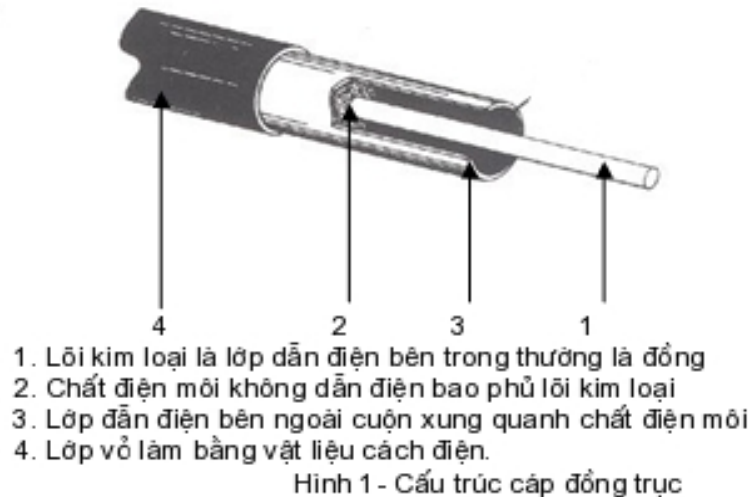
Hình 2.11 Cấu tạo cáp đồng trục
