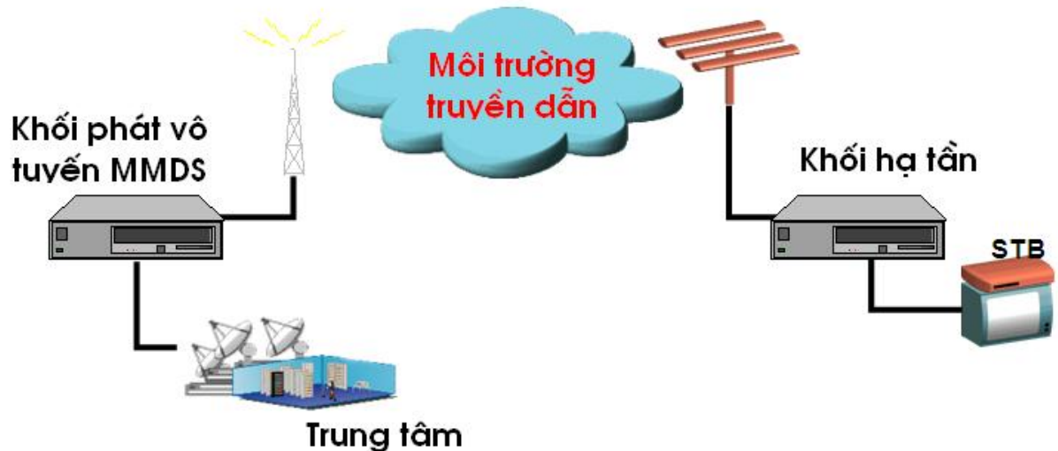
Hình 1.2.2: Cấu hình mạng phân phối đa kênh đa điểm MMDS.
