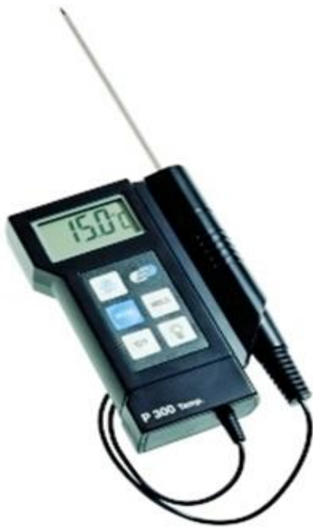
Hình 1.17. Thiết bị đo nhiệt độ chuyên nghiệp P400/P410[12]
