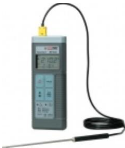
Hình 1.16. Thiết bị đo nhiệt độ lò Model MP 200[12]
