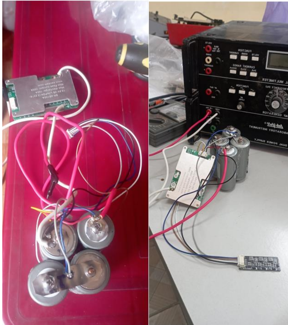
Hình 3.16: Tiến hành đo và sạc pin
