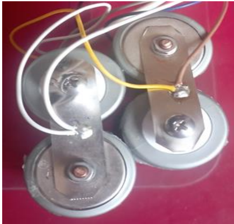
Hình 3.15: Hàn dây vào các điểm đã xác định
