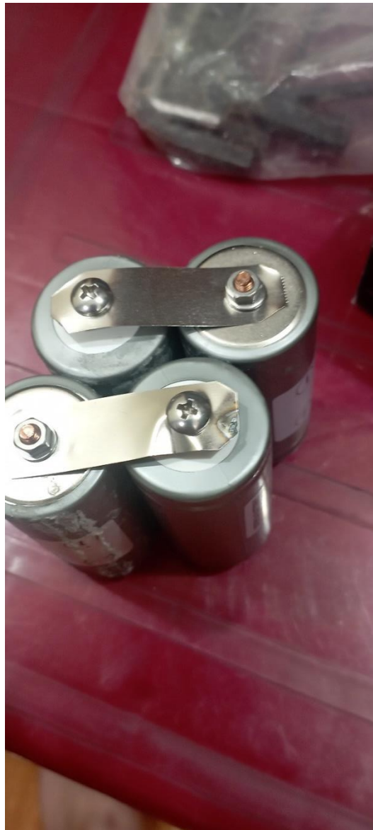
Hình 3.13: Cố định các cell pin
