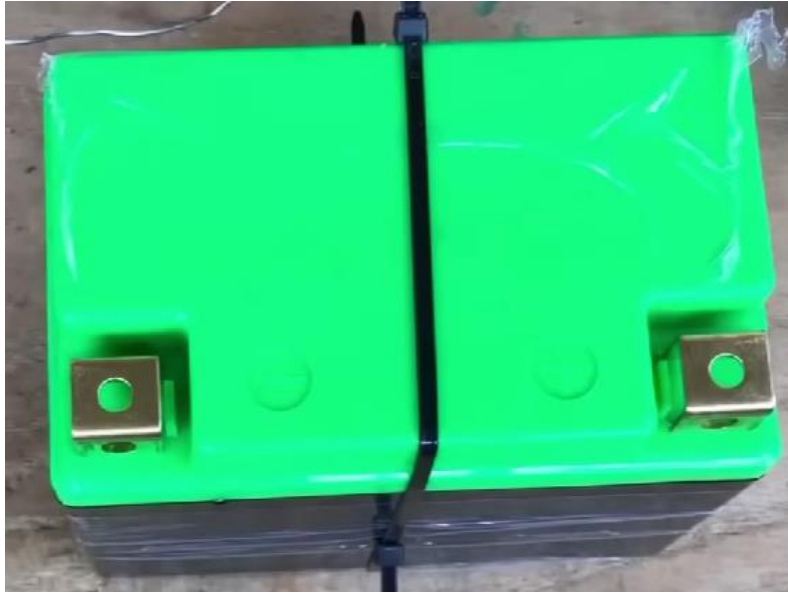
Hình 3.17: Cố định pin vào vỏ ắc quy
