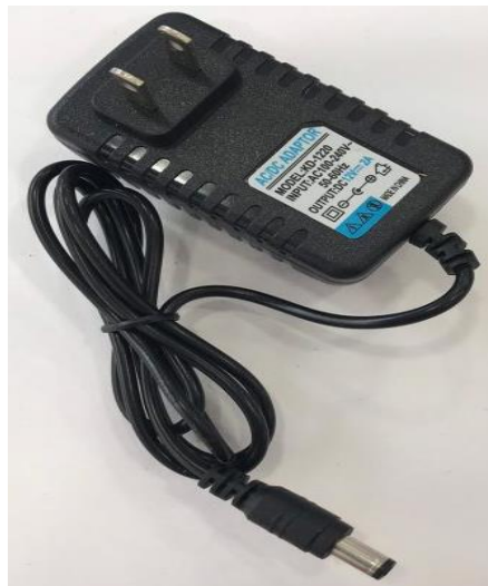
Hình 1. 5. Mạch chuyển nguồn từ AC~220V sang DC-12V
