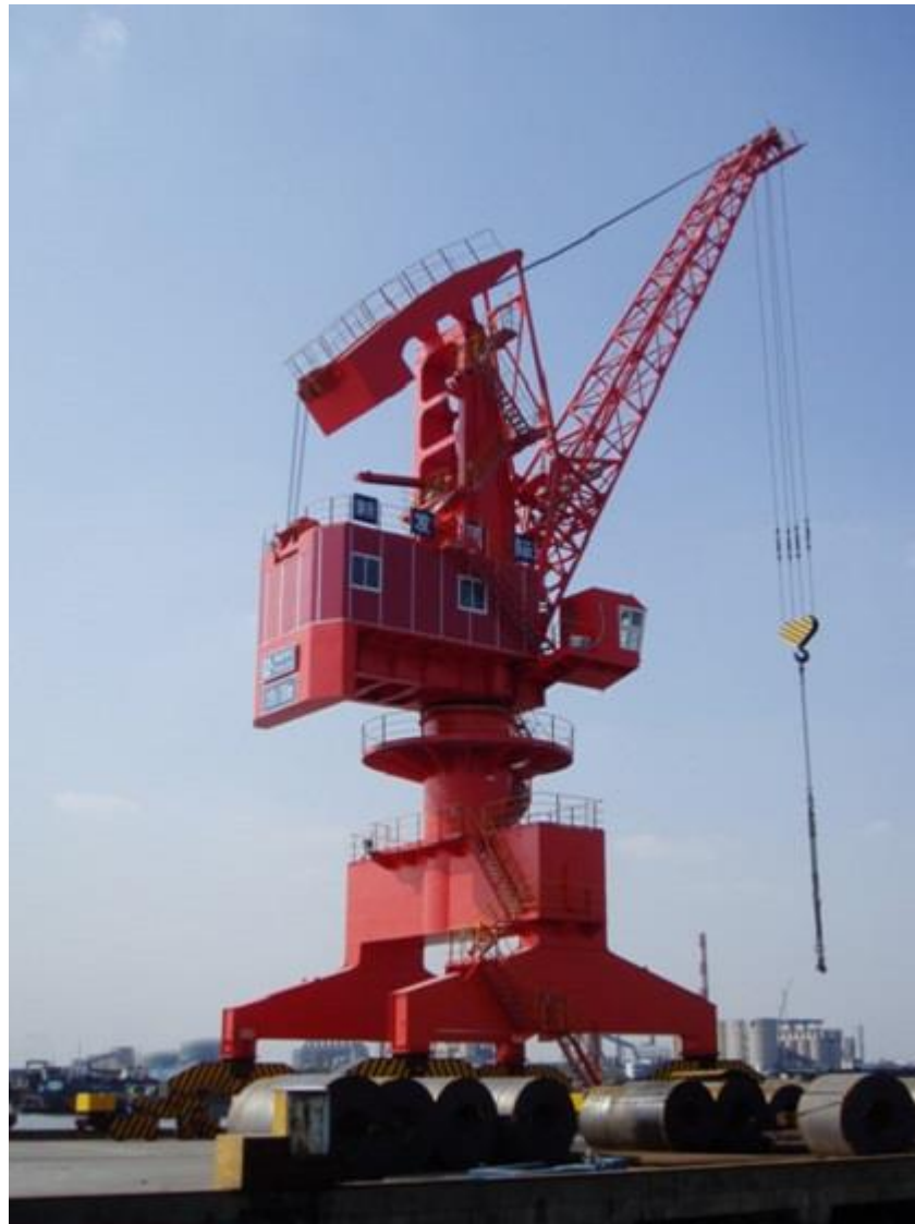
- Hình 1.10 cầu trục chân đế
