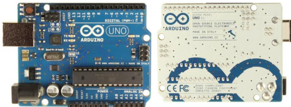
Hình 1.10. Mặt trước, mặt sau và bố trí chân thực tế của KIT Arduino Uno R3.
