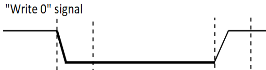
Hình 2.17 Dạng sóng gửi bit 0 của chuẩn One-Wire
