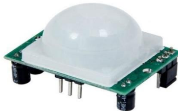
Hình 2.7 Cảm biến chuyển động PIR HC – SR501
