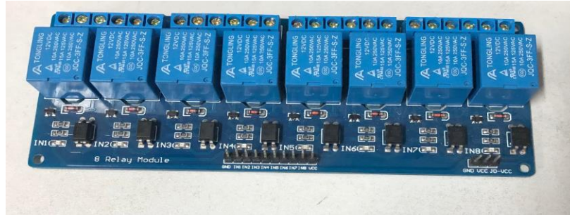
Hình 3.2 Module 8-Relay 5V
