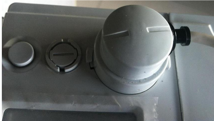
Hình 4.9.1.2 Đầu truyền thông quang bắt chặt dây cáp lập trình
