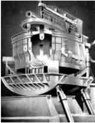
Hình 22.9 Lò hồ quang nấu thép (số 3 là điện cực).
