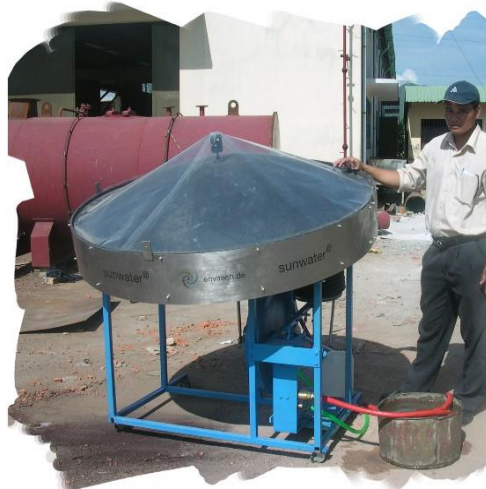
Hình 2.10. Bơm nước chạy bằng NLMT
