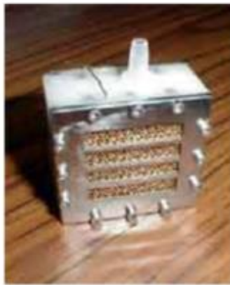
Hình 1.1. Pin nhiên liệu do Phân Viện vật lý tại thành phố HCM chế tạo
