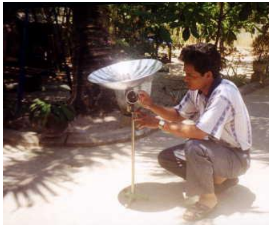
Hình 2.9. Động cơ Stirling dùng NLMT
